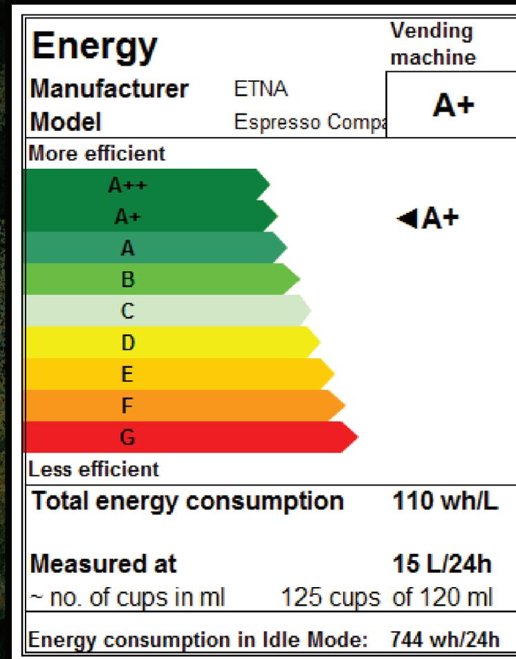
Die Maschine hat das effizienzklasse A+ gemäß EVA Energy Measurement Protocol Version 3.1B.
