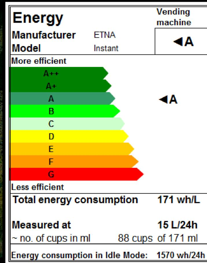
Die Maschine hat das Label A gemäß EVA Energy Measurement Protocol Version 3.1B.
